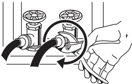
**REMARQUE :** Ne pas serrer excessivement ou utiliser du ruban adhésif ou un calfeutrant sur la valve. Les valves risquent d'être endommagées.
